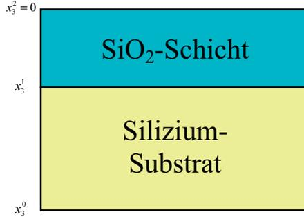
**Abbildung 3.6:** Mehrschichtsystem zur Transformation der Randbedingungen an die aktive Grenzschicht.
