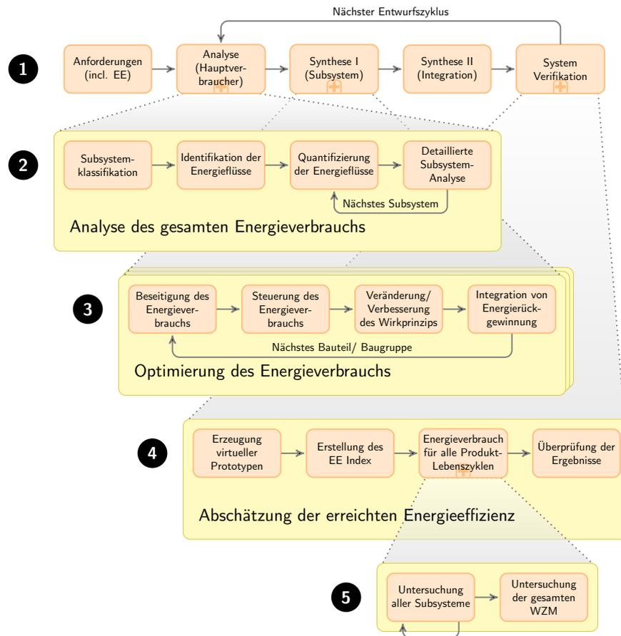
Abbildung 5.4: Hierarchischer Workflow des energiesensitiven PEP für Werkzeugmaschinen.
