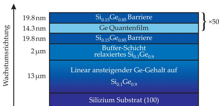
Abbildung 4.1.: Schematische Darstellung der untersuchten Ge/SiGe-Probe.
