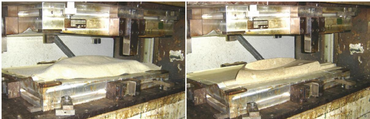
**Abb. 35:** Fertigung eines GPR-Verbundbauteils im Versuchswerkzeug Typ E-87. Mit PUR-Harz beschichtetes GPR-Halbzeug (links) und konsolidiertes Formteil (rechts)
