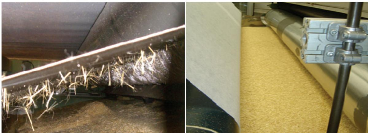
**Abb. 11:** Materialverluste bei der Ablieferung vom Vorvliesbildner V21/R zur Wirrvlieskarde K12 (links) und gleichmäßiges Faservlies vor der Vernadelung (rechts)
