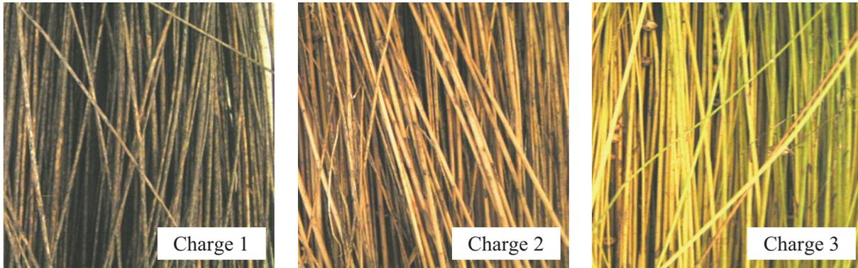
**Abb. 18:** Flachsstroh mit unterschiedlichem Röstgrad
