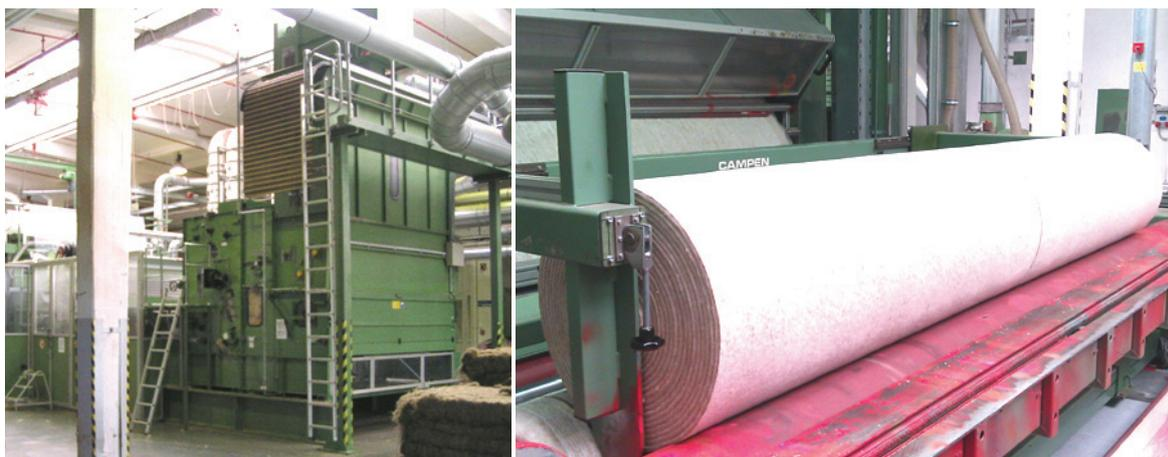
**Abb. 63:** Verwendete Vliesanlage (links) und fertige GPR-Halbzeugrolle (rechts)
