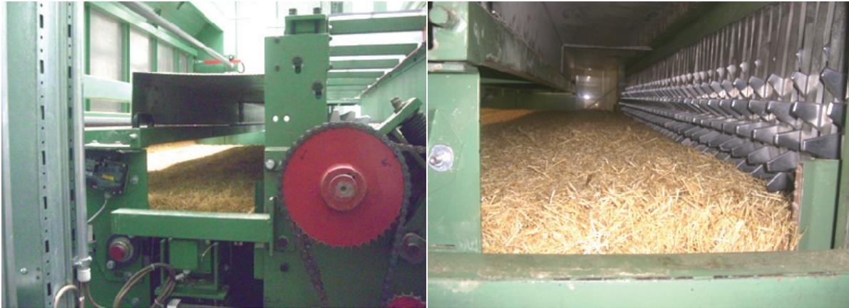
**Abb. 10:** Materialablieferung vom Rüttelschachtspeiser zur Bandwaage (links) und Materialzuführung zum Vorvliesbildner V21/R (rechts)
