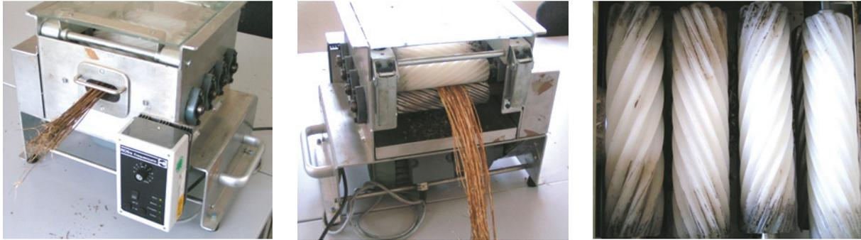
**Abb. 19:** Verwendeter Laborentholzer Flaksy<sup>®</sup> der Fa. Bahmer Maschinenbau
