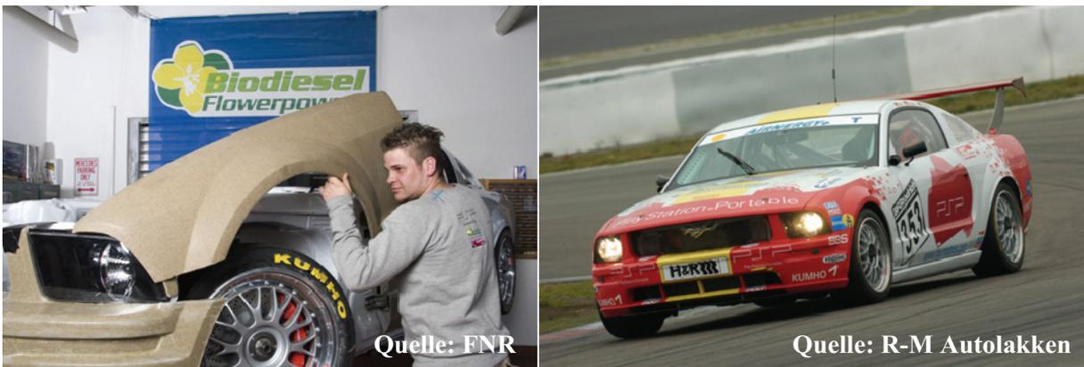
**Abb. 4:** Bioconcept-Car (links: NFK-Kotflügel und -Stoßstange; rechts: Testfahrzeug mit NFK-Anbauteilen)
