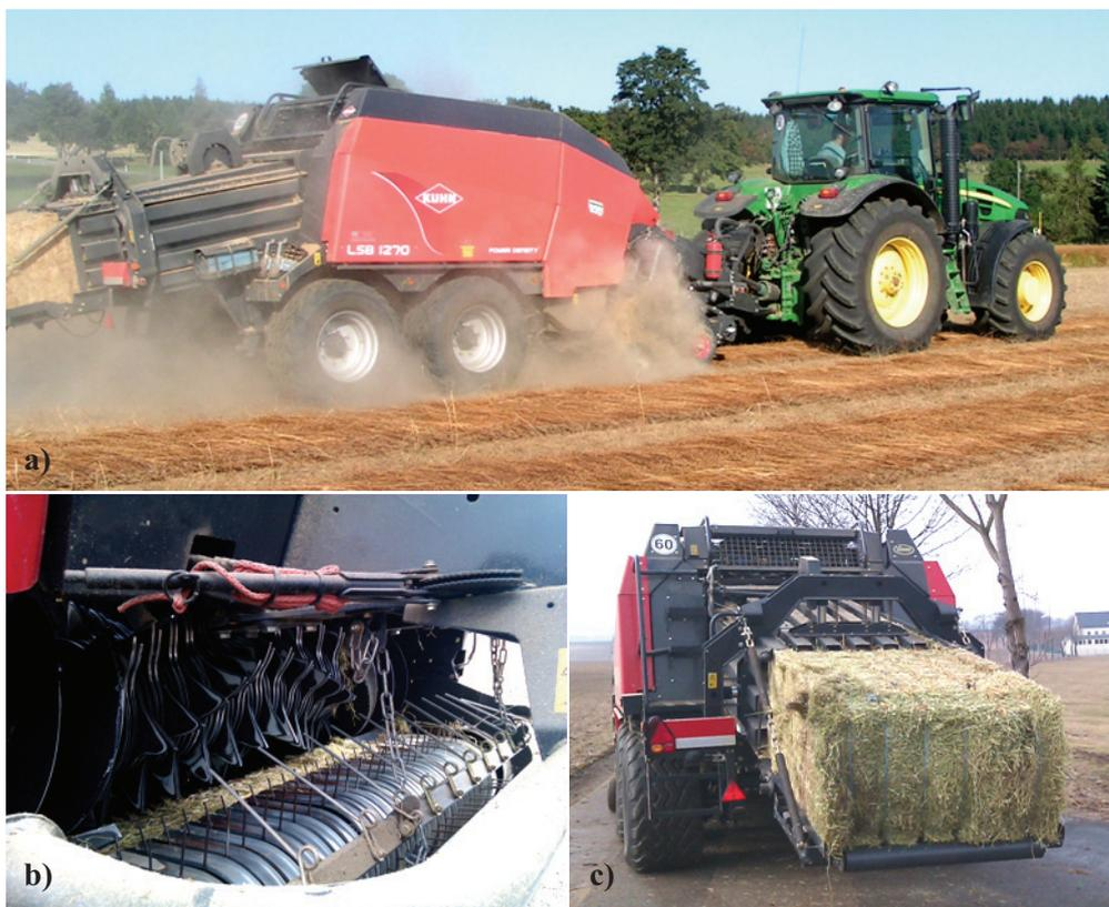
**Abb. 62:** Feldversuch zur Bereitstellung des GPR Grünflachs als Quaderballen für das entwickelte Verfahren zur Halbzeugherstellung: a) Ballenpresse im Einsatz, b) Integriertes Schneidwerk der Ballenpresse und c) Fertiger Quaderballen aus GPR Grünflachs
