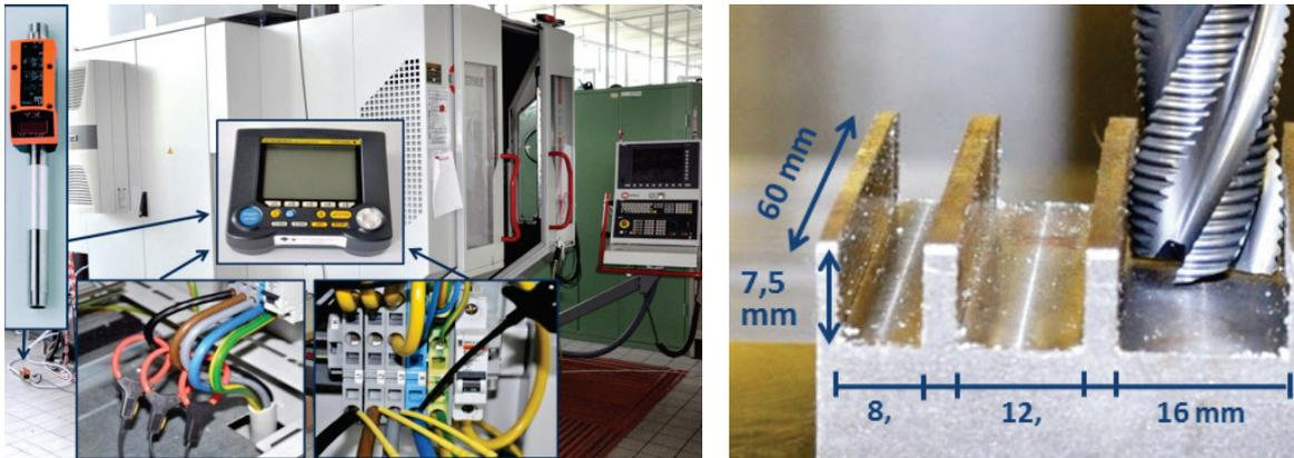
**Bild 4:** Leistungs- und Druckluftmessung an einem Bearbeitungszentrum im Vollschnitt
