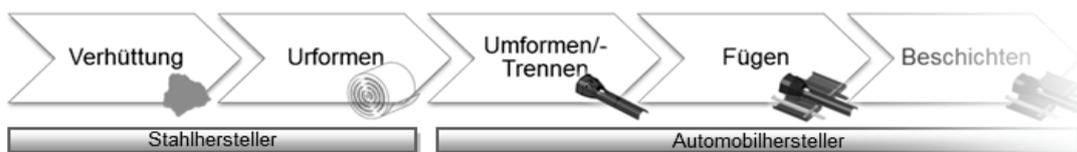
**Bild 3:** Schematischer Veredlungsprozess in der Automobilindustrie nach [8]
