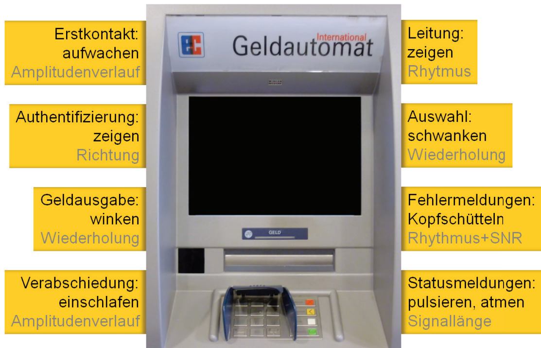
Abbildung 2: Beispiel einer erfolgten Mensch-Maschine-Biomorphisierung: die Ausgabesignale sind in menschliche Verhalten übersetzt und mittels passender Signale kodiert
