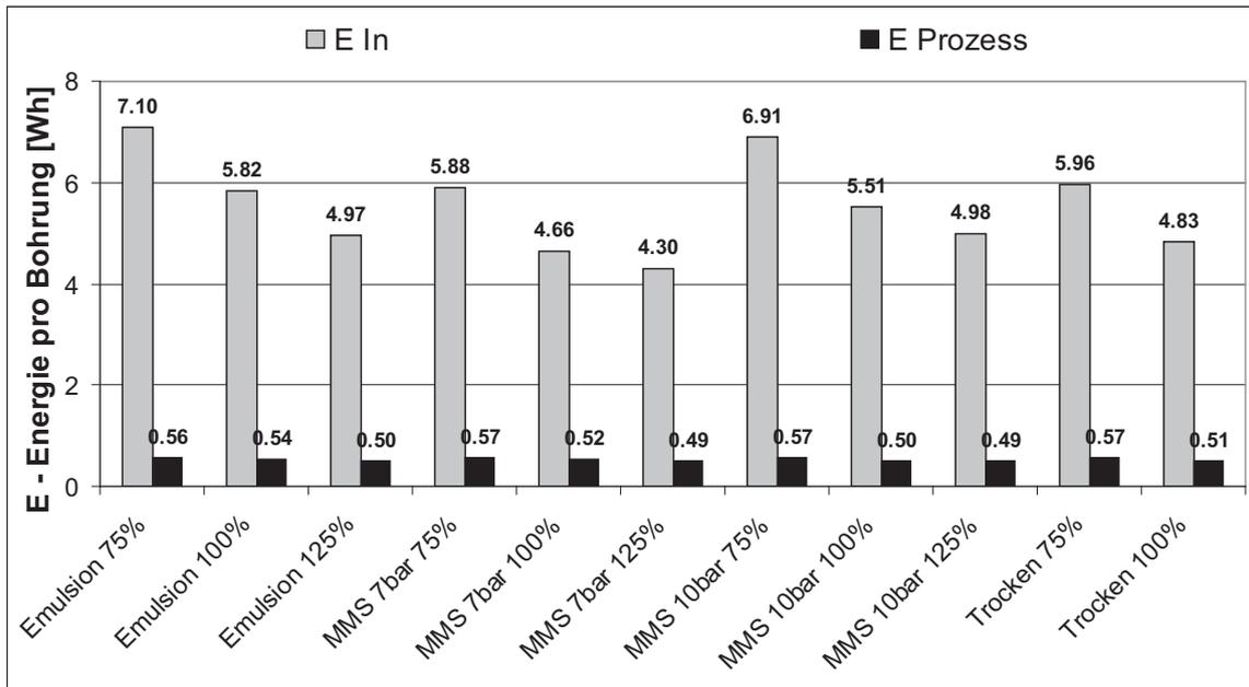
**Bild 4:** Summe der Energieeinträge in die Maschine  $E_{in}$  und Prozessenergie
