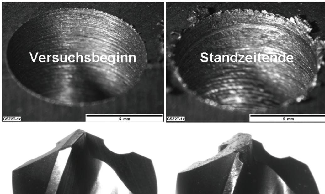
Bild 6: Gratform und lichtmikroskopische Bohrer Aufnahme bei Versuchsbeginn und Standzeitende
