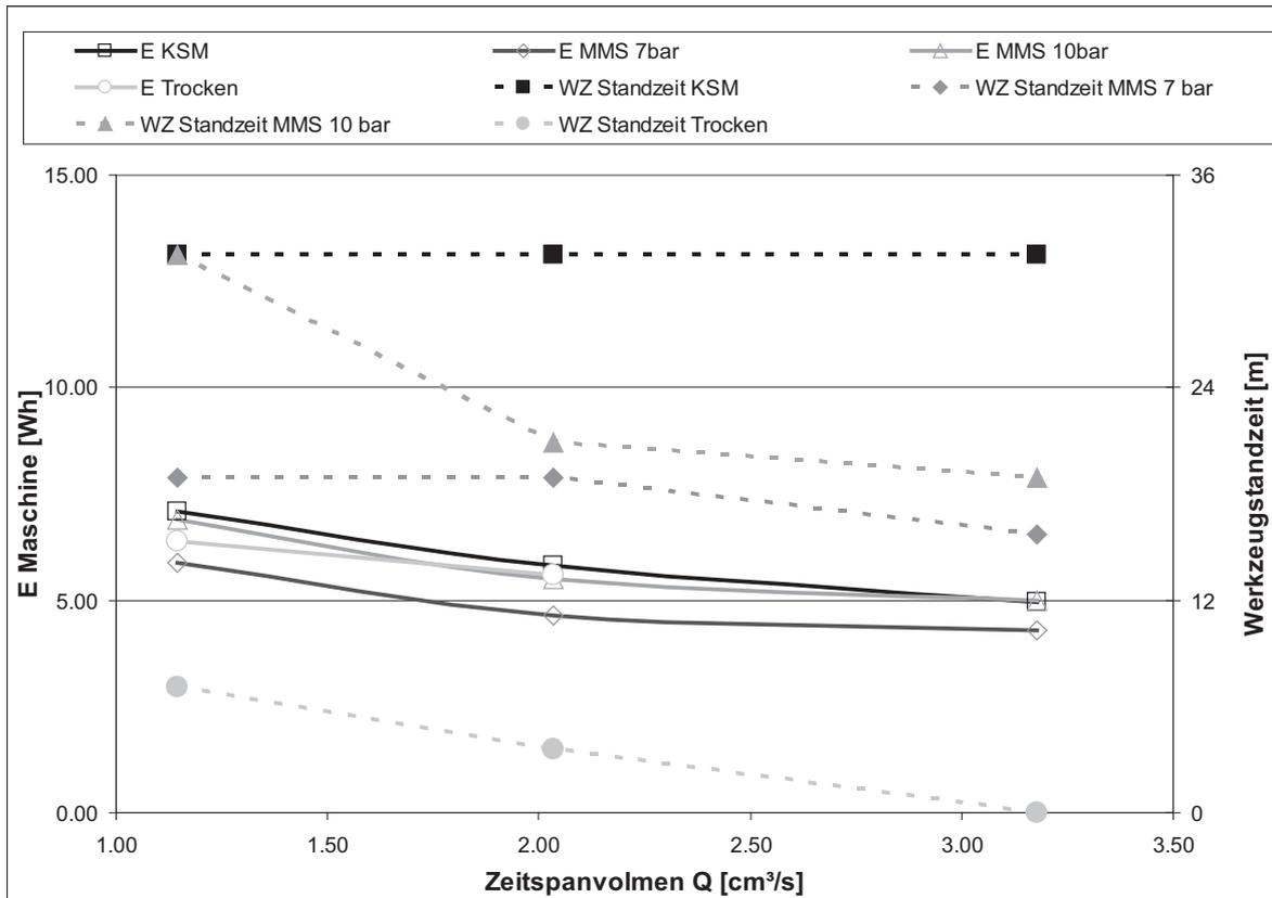
Bild 5: Bohrerstandweg und  $E_m$  bei verschiedenen Kühlschmierstrategien und Zeitspanvolumen
