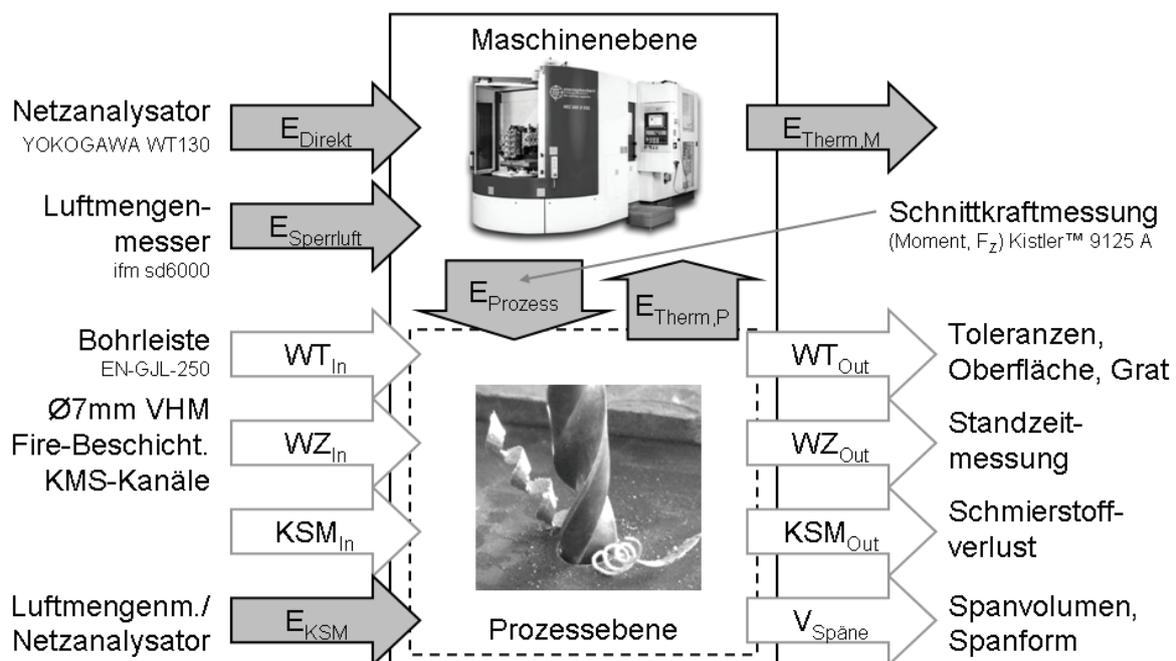
**Bild 2:** Versuchsaufbau der Bohrversuche mit verschiedenen Kühlschmierstrategien
