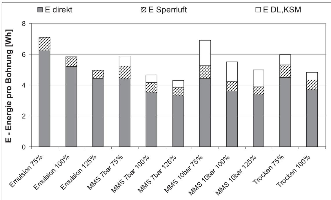
**Bild 3:** Energieverbrauch verschiedener KSM-Systeme und Zeitspannvolumen pro Bohrung
