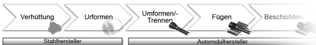
Bild 3: Schematischer Veredlungsprozess in der Automobilindustrie nach [8]
