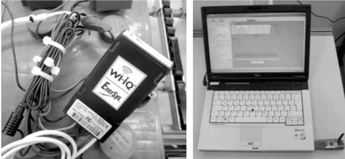
**Bild 7:** Batteriecontroller am FTF (links) sowie Messwerterfassung (rechts)
