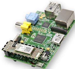
Bild 1: Raspberry Pi mit aufgestecktem RaspBee (dunkel eingerahmt)
