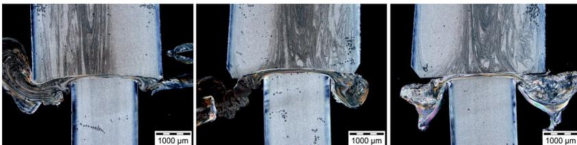
**Bild 5.6:** Einfluss der Amplitude bei ungleichen Wandstärken unter Querschwingung;
