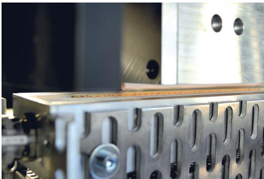
**Bild 4.7:** sichtbare Schmelzbildung während der IR-Vorwärmung der Plattenprüfkörper;
