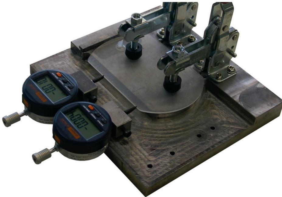
Abbildung 3-2: Messaufnahme zum Vermessen der Versuchsteile
