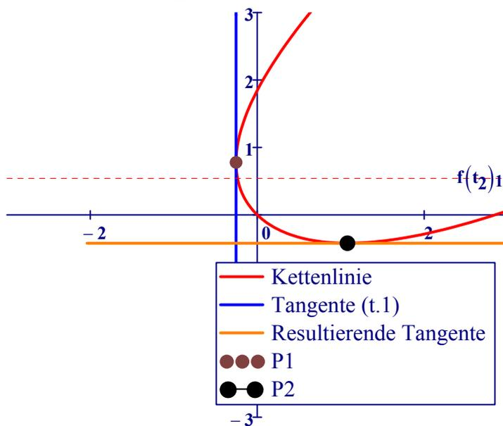
Die Berührungspunkte sind die Punkte auf den Kurve  $f(t)$  zu den Parameterwerten  $t_1$  und  $t_2$  der beiden Tangenten. Die Koordinaten lassen sich mittels der Drehung leicht bestimmen. Es gilt  $P_i = f(t_i)$ . Nach der Drehung besitzen die Punkte die Koordinaten  $P_i = Df(t_i)$
