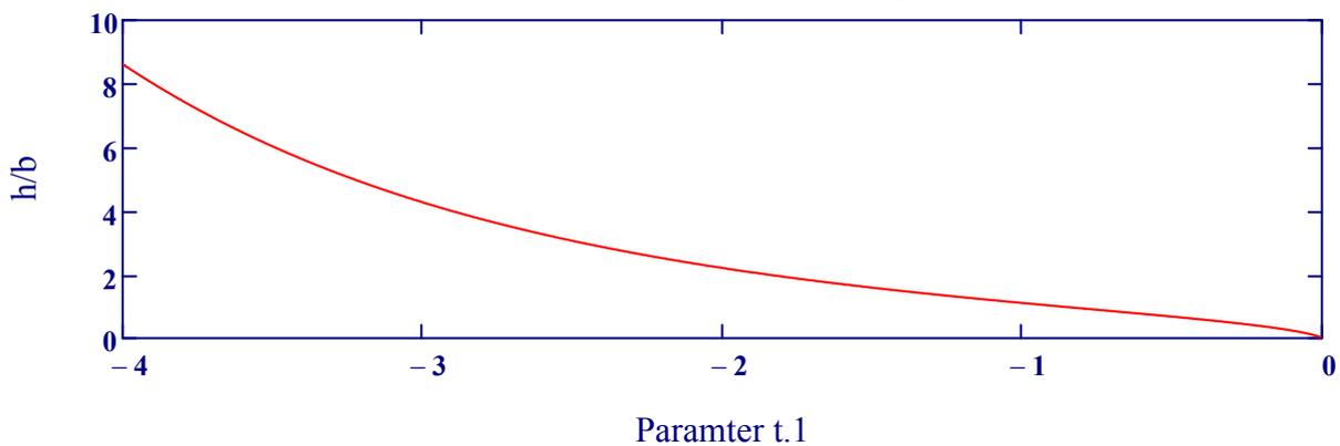
Zu einem vorgegebenen Verhältnis aus Höhe zu Breite kann  $t_1$  durch Lösen der nichtlinearen Gleichung bestimmt werden. (**vhb** bezeichnet die Funktion "Verhältnis Höhe/Breite")
