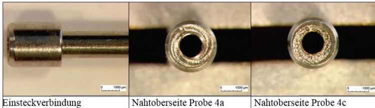
*Bild 10: Laserstrahlmikroschweißung einer I-Naht am Parallelstoß an einer Rohreinsteckverbindung mit einem gepulsten Festkörperlaser*
