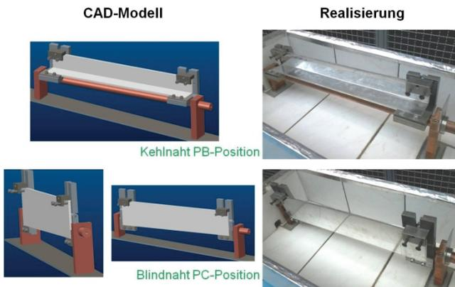
*Bild 3: Kalorimeter und Spannvorrichtung zur Fixierung der Bauteile*
