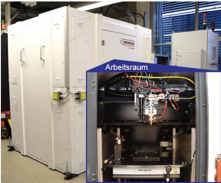
Bild 4: Laserbasiertes Schweiß- und Schneidsystem microWELD [2]
