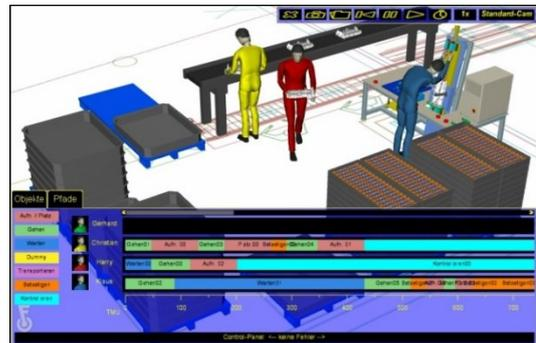
**Abbildung 47: Simulation einer Station zur Nockenwellenmontage**
