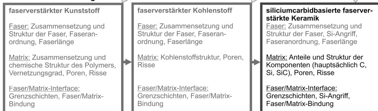
Abbildung 31: Übersicht über die Variablen beim Flüssigsilicierverfahren zur anforderungsgerechten Auslegung des Verbundwerkstoffes (Verbundwerkstoffdesign)
