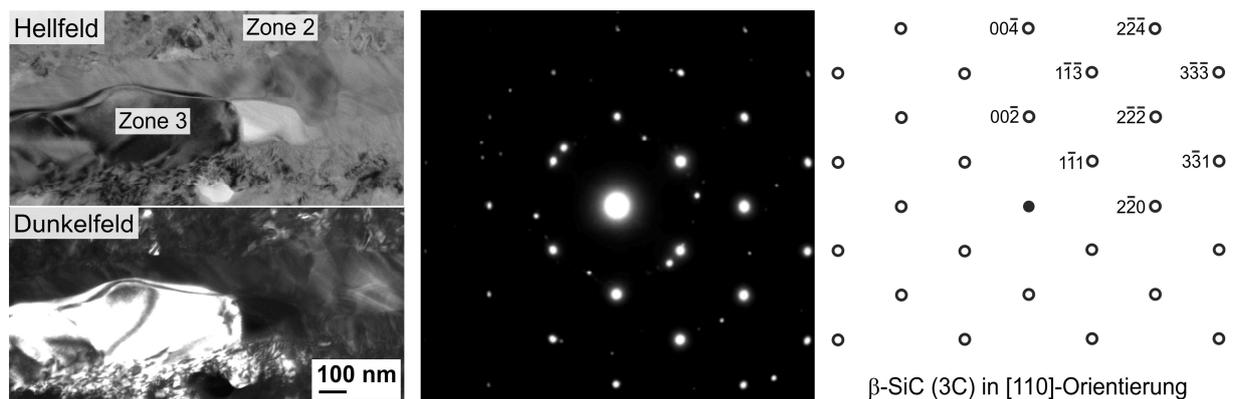
Abbildung 49: C/C-SiC-Verbund aus PF-Harz 1; links: Hellfeld- und Dunkelfeld-TEM-Aufnahme in Zone 3; mittig: SAED-Aufnahme; rechts: Indizierung des einkristallinen Anteils in der SAED-Aufnahme
