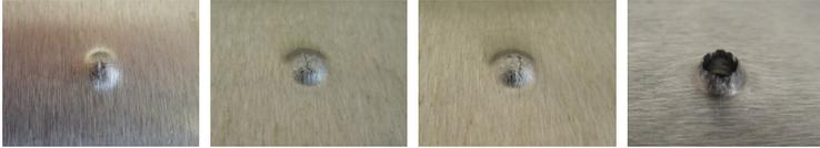
**Abbildung 4.11:** Rissbildung während der Buchsenbildung auf der Unterseite des Magnesiumbleches mit sprödem Aufklaffen des Buchsenbodens
