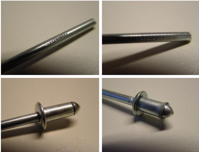
**Abbildung 4.4:** Links: Nietdorn und Nietkopf nach Blechdurchdringung bei hoher Drehzahl und stabilem Prozess; Rechts: geschädigter Nietdorn und Nietkopf bei niedrigen Drehzahlen mit Schleifspuren und einer leicht eingeformten Niethülse
