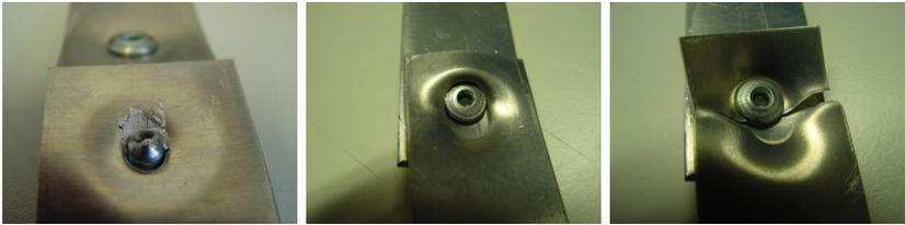
**Abbildung 4.37:** Versagen unter Scherzug bei Metall/Metallverbindungen; links: Abscheren des Nietes; mitte: Lochleibung; rechts: Spaltbruch
