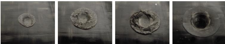
**Abbildung 4.9:** Eindringen des Metallblechs in den FKV unter Aufschmelzen des Matrixmaterials.
