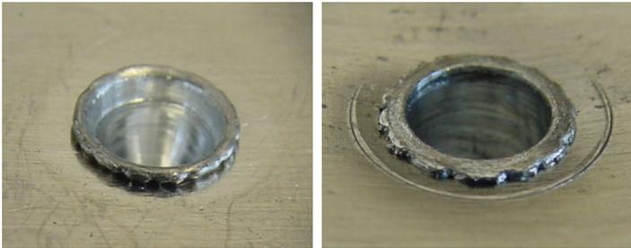
**Abbildung 4.6:** Links: Noch nicht fertig ausgebildete Buchse mit einem Kranz aus aufgestiegenem Material; Rechts: Bei der fertig ausgebildeten Buchse wird der Kranz durch das Auftreffen des Setzkopfes verformt
