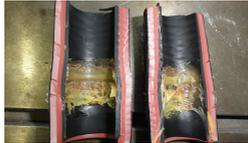
(b) Muffe M\_18: Isolierkörper
