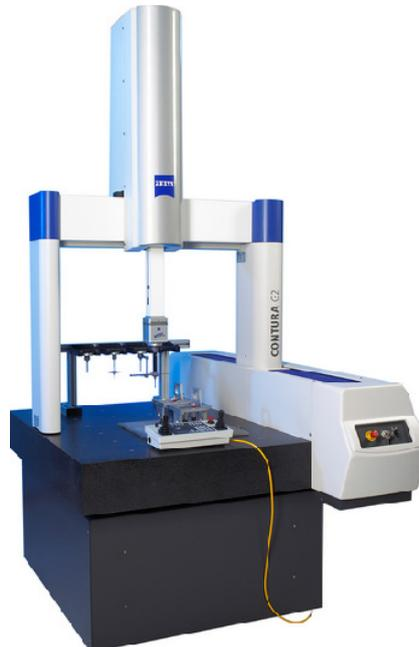
**Abbildung 7.25: KMG (Zeiss Contura G2)**
