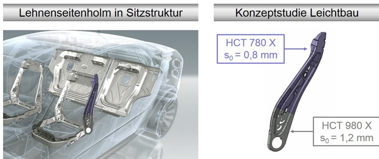
**Abbildung 4.2: Leichtbaukonzept Lehnenseitenholm nach [HAR10]**
