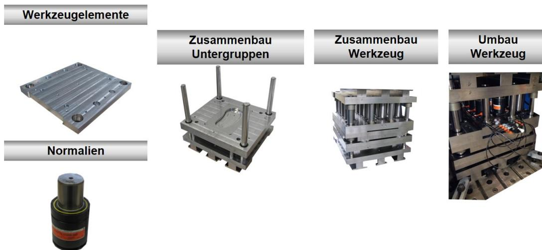
**Abbildung 7.11: Zusammenbau Werkzeug**
