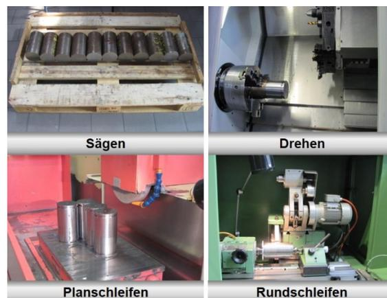
Abbildung 7.9: Fertigung der Werkzeugbauteile (Distanz)
