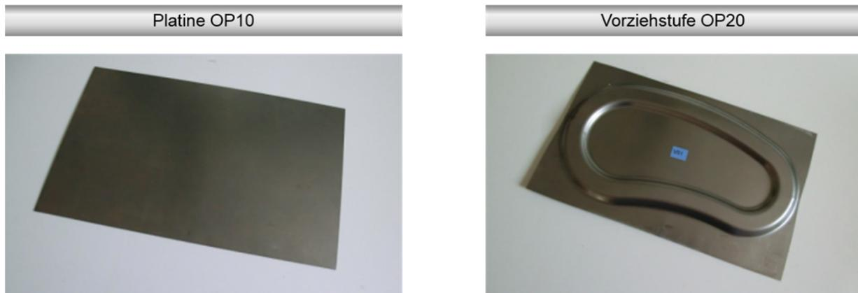
**Abbildung 7.19: Geschlossener Demonstrator vor und nach der Vorziehstufe OP 20**
