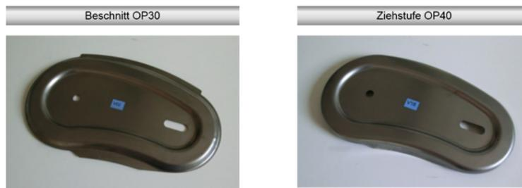
**Abbildung 7.23: Geschlossener Demonstrator vor und nach Ziehstufe OP40**
