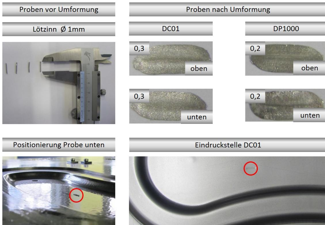
**Abbildung 7.17: Zinndrahtumformung**
