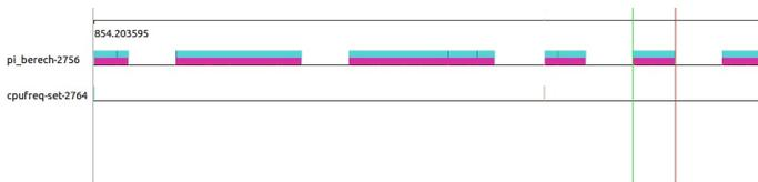
Abbildung 5.3: Messung der maximalen Rekonfigurationszeit
