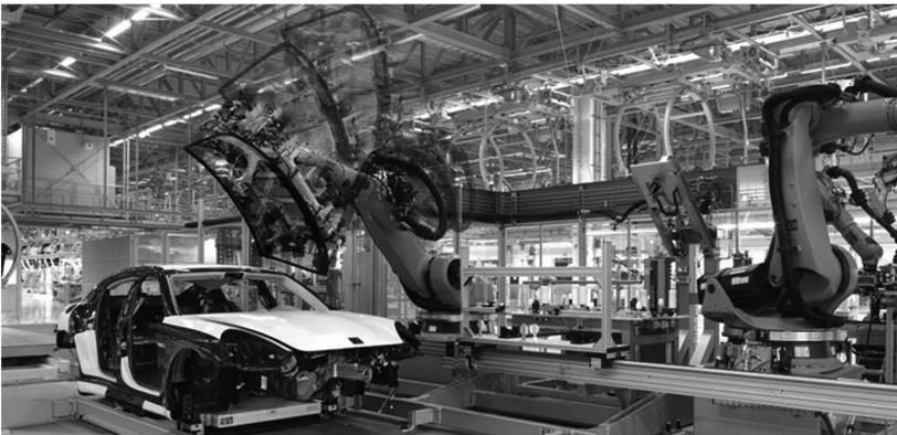
Abb. 1.2: Montage der Front- und Heckscheibe durch Roboter [Por17]
