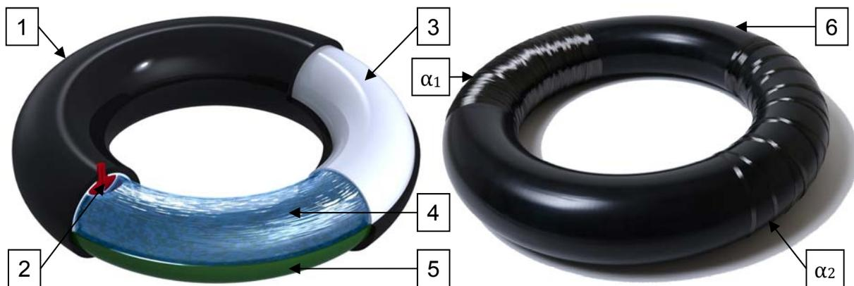
Abbildung 3: links: CAD-Konstruktion RDB Typ LSE 1.4; rechts: Wicklungsdemonstrator mit PU-Liner
