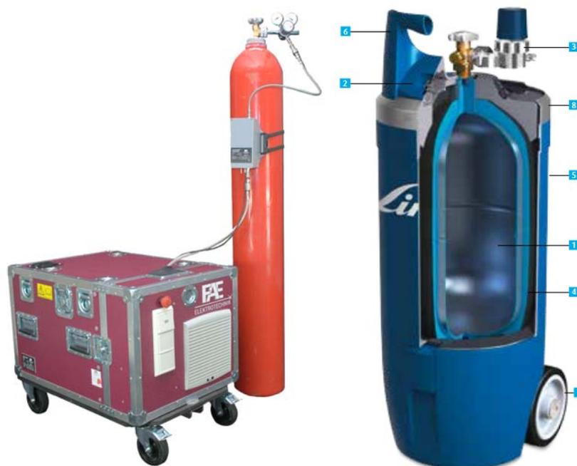
Abbildung 1: links: Brennstoffzellenbetriebener mobiler Energieerzeuger der Firma FAE Elektrotechnik GmbH & Co. KG mit 1 kW und einer Standard-Stahlgasflasche (Füllvolumen 8,9 m<sup>3</sup>, Fülldruck 200 bar, Gewicht 80 kg), rechts: GENIE<sup>®</sup>-Gasflasche (Füllvolumen 5 m<sup>3</sup>, Fülldruck 300 bar, Gewicht 32,7 kg) der Linde AG ([www.linde-gas.com/genie](http://www.linde-gas.com/genie))
