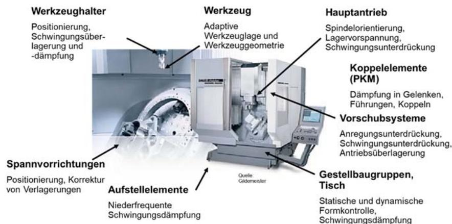
**Bild 5:** Beispiele für additive mechatronische Systeme in WZM (nach [133])
