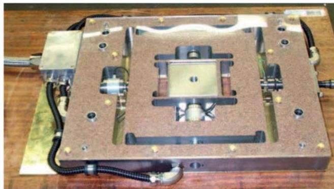
**Bild 24:** Aktive Werkstückaufspannfläche [55]
