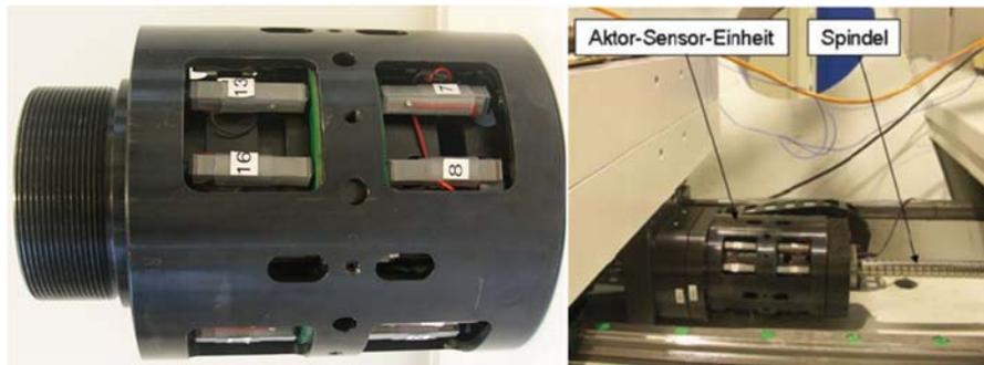
**Bild 6:** Aktor-Sensor-Einheit zur Schwingungskompensation (links) im eingebauten Zustand (rechts) [236]
