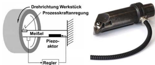
**Bild 22:** Schematische Darstellung (links) und reale Ausführung (rechts) eines aktiv gedämpften Drehmeißelhalters (nach [68])
